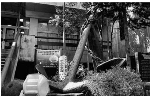
ディアナ号の錨。二〇〇トンの 船に相応しい立派な錨だ。重さ約 四トン 長さ四・八メートル
