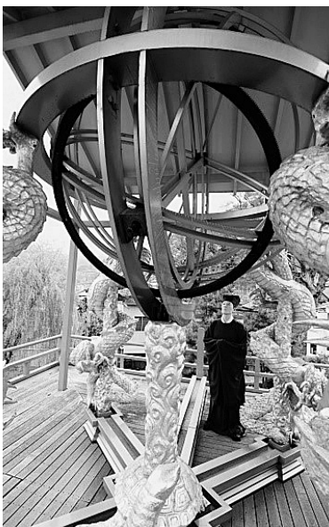
最上階にある渾儀（正座の位置を観測する計器）等身大の人形は中国元の時代の天文学者 郭守敬
